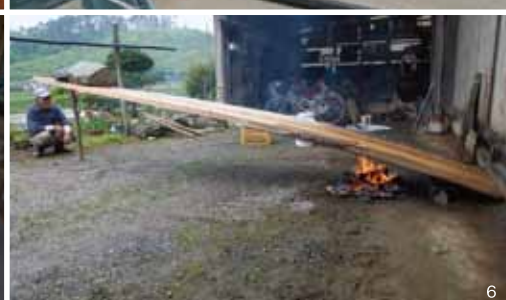
1.製作工程[組立]／2.製作工程[板図]／3.船模型(縮尺1／32)／4.進水式イメージ／5.製作工程[シキづくり]／6.製作工程[焼曲げ]
