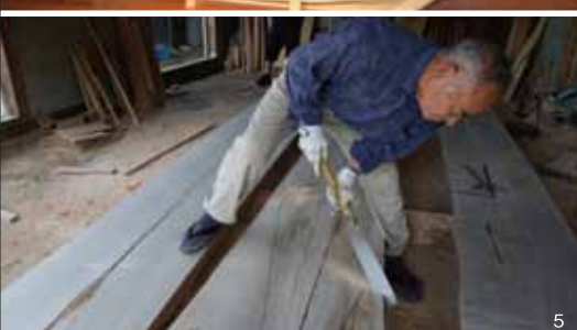
1.製作工程[組立]／2.製作工程[板図]／3.船模型(縮尺1／32)／4.進水式イメージ／5.製作工程[シキづくり]／6.製作工程[焼曲げ]
