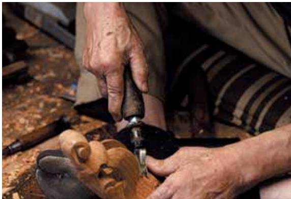
上：首の曲がった匙鑿で墨池の底をさらう 下：三角刀を備えた電動チゼルで掘り進める
