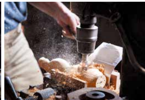
「彫り機」で墨池を荒彫り。型に合わせてビットが動く
