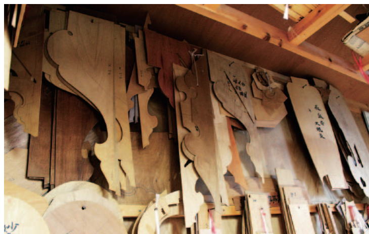
曲線を形作るための型板(鶴工舎製作)
